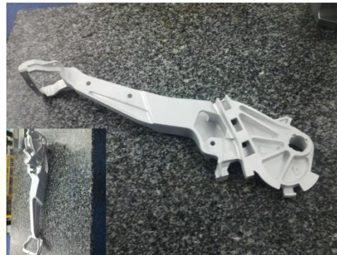
PROTOTIPO MECANIZADO CNC CON ALUMINIO 7075 T6 + PULIDO + ARENADO
